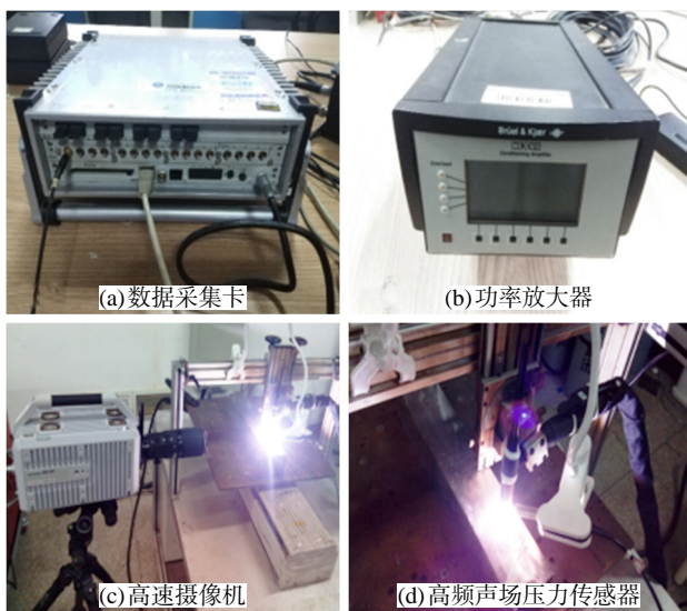
图 2 GTAW 自激发超声试验平台中部分的设备实物照片
